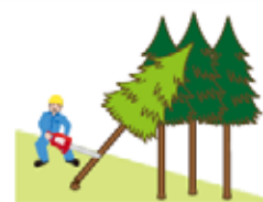
（図5）かかっている木の元玉切り
