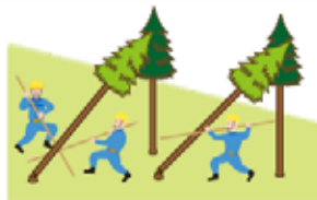
（図2）かかり木の処理
