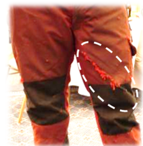
写真 3.5 使用しては いけない防護ズボン
