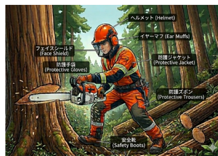
図 3.13 チェーンソー作業時の防護装備
