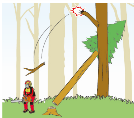
図 3.32 大径木伐倒に伴う枯れ枝の飛来・落下
