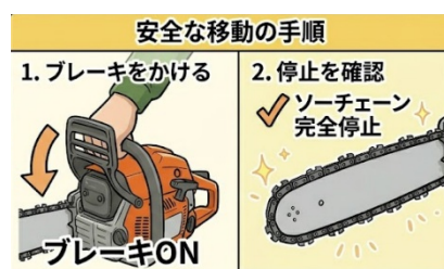
図 3.19 移動する時にはチェンブレイキをかける
