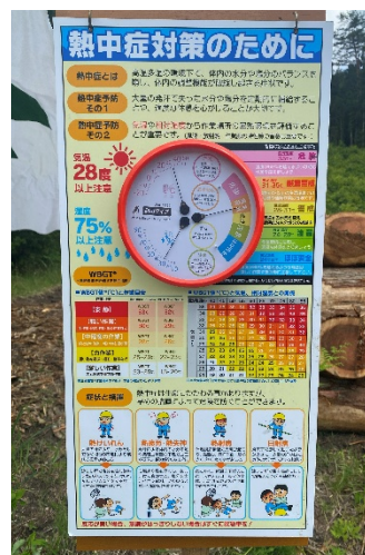
写真 3.2 熱中症災害 注意喚起現場表示看板
