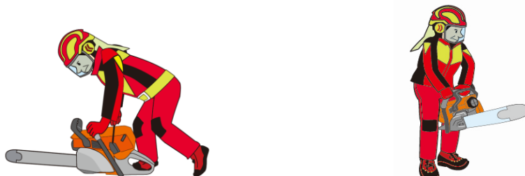
図 3.14 始動は原則として地面に置いて始動 股がけは推奨されていません
