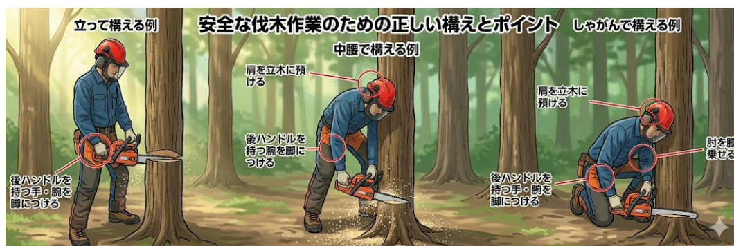
図 3.16 チェーンソーは身体の一部及び原木で支えて使用する
