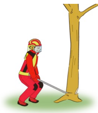
図 3.31 小径木のフェリングレバー伐倒
