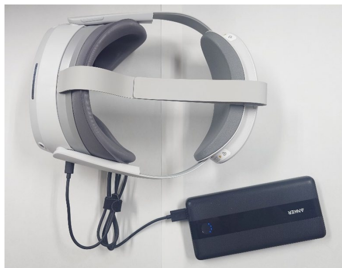
VRヘッドセットの補助電源接続例 (USB-C⇔USB-Aケーブル、モバイルバッテリーは参考)
