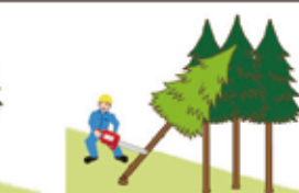
（図5）かかっている木の元玉切り
