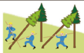
（図2）かかり木の処理
