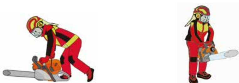
図 2.9 始動は原則として地面に置いて始動 股がけは推奨されていません
