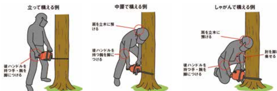
図 2.11 チェーンソーは身体の一部及び原木で支えて使用する
