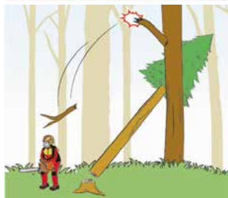
図 2.26 大径木伐倒に伴う枯れ枝の飛来・落下
