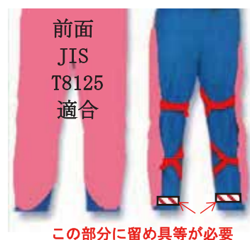
図 2.6 規則に適合するチャップスの条件
