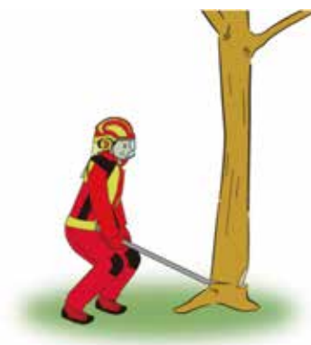
図 2.25 小径木のフェリングレバー伐倒
