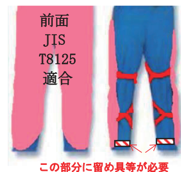
図 2.4 規則に適合するチャップスの条件
