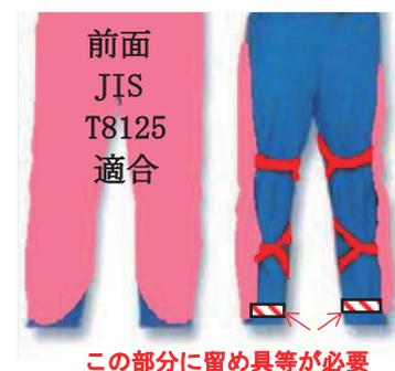
図 2.4 規則に適合するチャップスの条件
