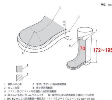
図 2.5 JIS T8125-3 に適合する履物
