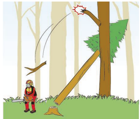
図 2.23 大径木伐倒に伴う 枯れ枝の飛来・落下
