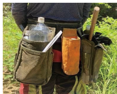
写真 2.4 腰袋のペットボトルによる危険な燃料管理
