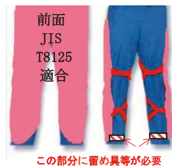
図 2.3 規則に適合するチャップスの条件
