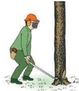
図 2.18 小径木のフェリングレバー伐倒
