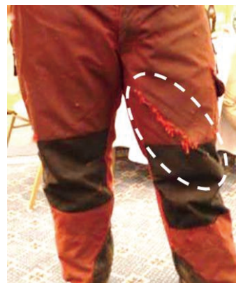
写真 2.3 使用してはいけない防護ズボン
