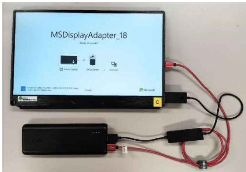
外部モニターの接続例2 （モバイルバッテリーを使用）
