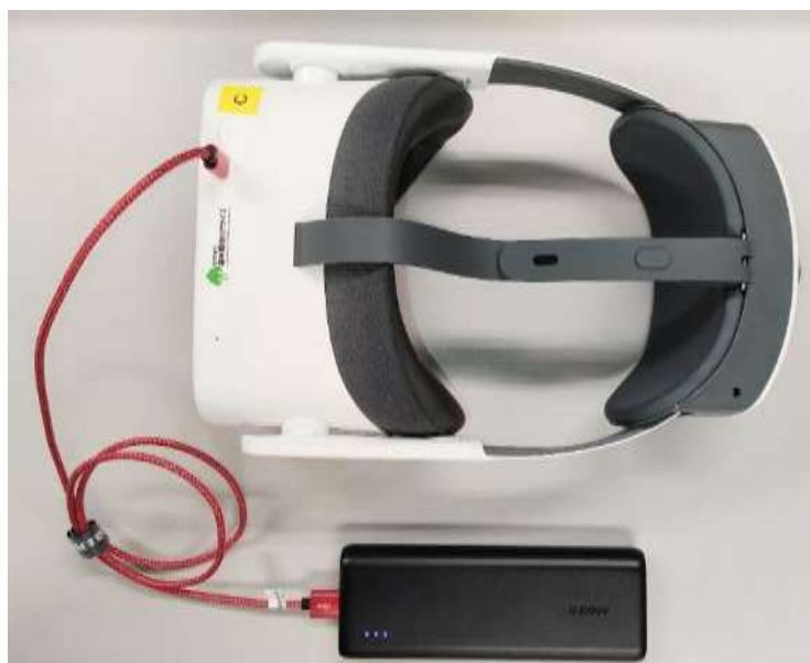
VRヘッドセットの補助電源接続例 (USB-C⇔USB-Aケーブル、モバイルバッテリーは参考)
