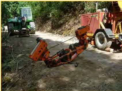
また、搬器 MM Sherpa U3 (左写真) は荷上げ力 3t、自重は約 410kg で、上げ荷・下げ荷など全地形に対応している。係留機能による横取りが可能である。
