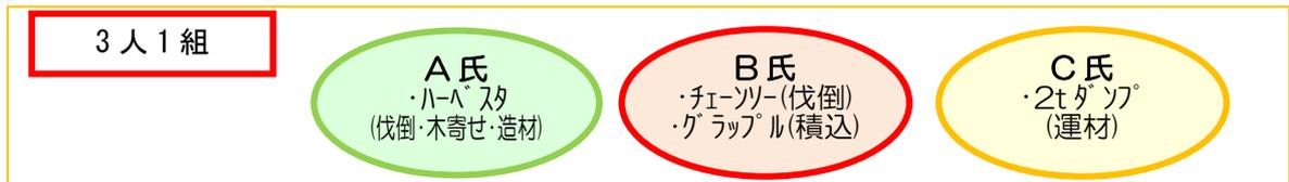
図 3.10 2t ダンプの 2 台使用時の各員役割分担
