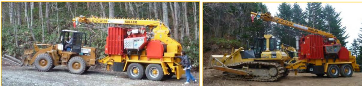
タワーヤードを牽引して林内路網を通過する際は、事前の路網整備が重要である。具体的に KOLLER K602H の場合、幅員 3.5m の確保と、急勾配部への路盤材の敷設が必要であった。
