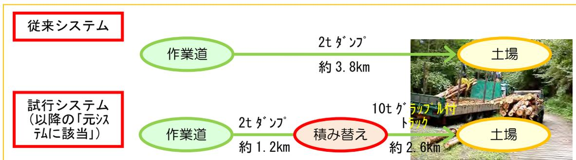
図 3.8 【試行システム①】グラップル付トラックへの積み替え
