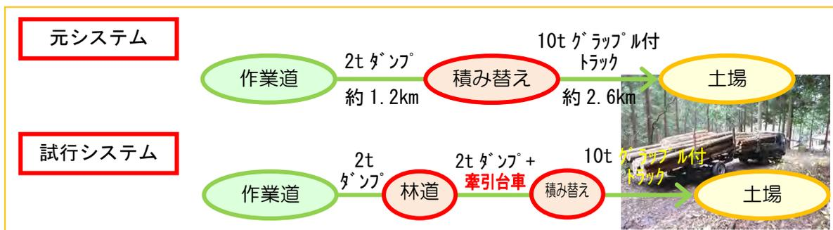
図 3.9 【試行システム②】牽引台車の導入
