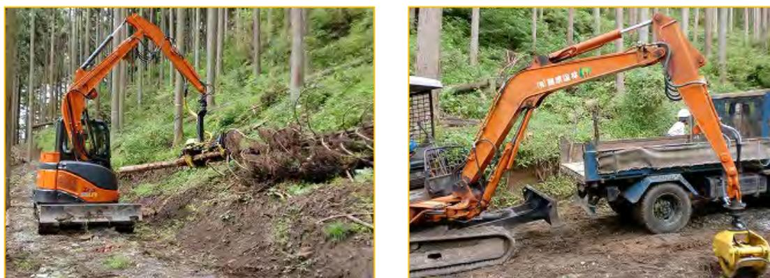
写真 3.5 導入済みの林業機械(左:LAハーベスタ、右:LAグラップルと2tダンプ)
