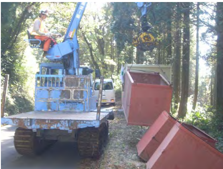
鉄製コンテナを利用した D材(短コロ)の運材
