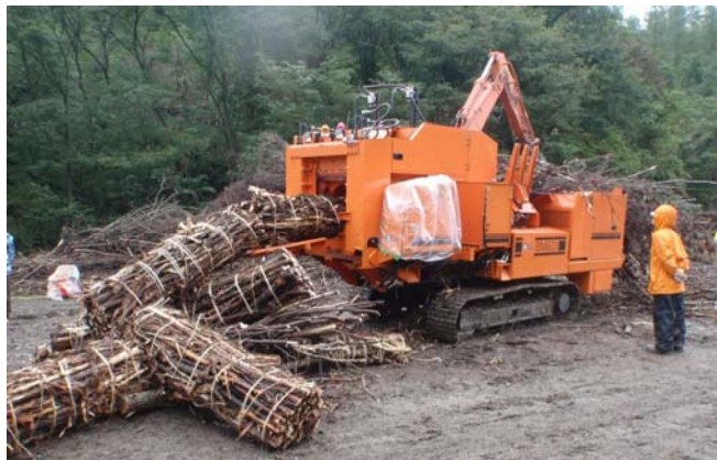
写真 4-4 バンドル試験の様子(バンドルの排出)
