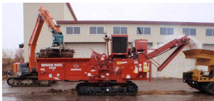
写真6 ウッドホグ2600によるバンドルのチップ化
