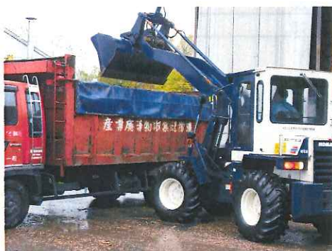
写真 2-2-2 ホイルローダーによるチップ積み込み
