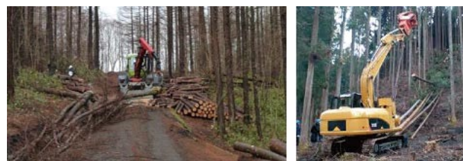
写真 5.12 高密路網によるウインチシステム・スイングヤーダ等による 全木・全幹集材の作業システム（土場に残材が集中する）
