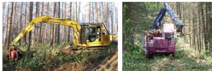
写真 5.11 ハーベスタ・フォワーダによる短幹集材作業システム（残材が林内に散らばる）
